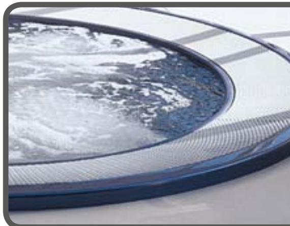
Élément distinctif des modèles Professional et Profile Pro, la grille de débordement qui entoure entièrement le spa présente une inclinaison de 15 degrés. L'eau qui « déborde » de la cuve en surface passe à travers cette grille jusqu'à un bac tampon. Une fois traitée par le système de filtration, l'eau est réinjectée dans le fond du spa au moyen d'une pompe.
