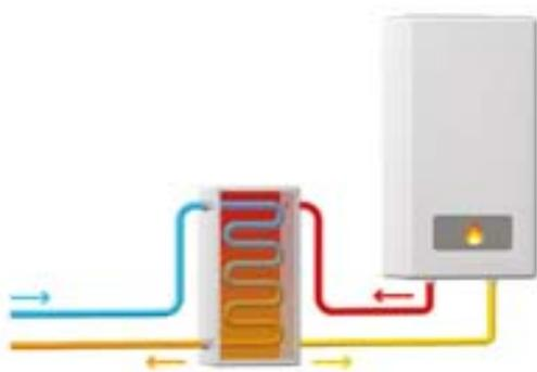
Les spas de la gamme Lodge peuvent être équipés d'un réchauffeur électrique supplémentaire ou d'un échangeur de chaleur, une solution écologique et économique qui exploite la chaleur produite par le système de chauffage ou toute autre source d'énergie renouvelable de votre établissement.
